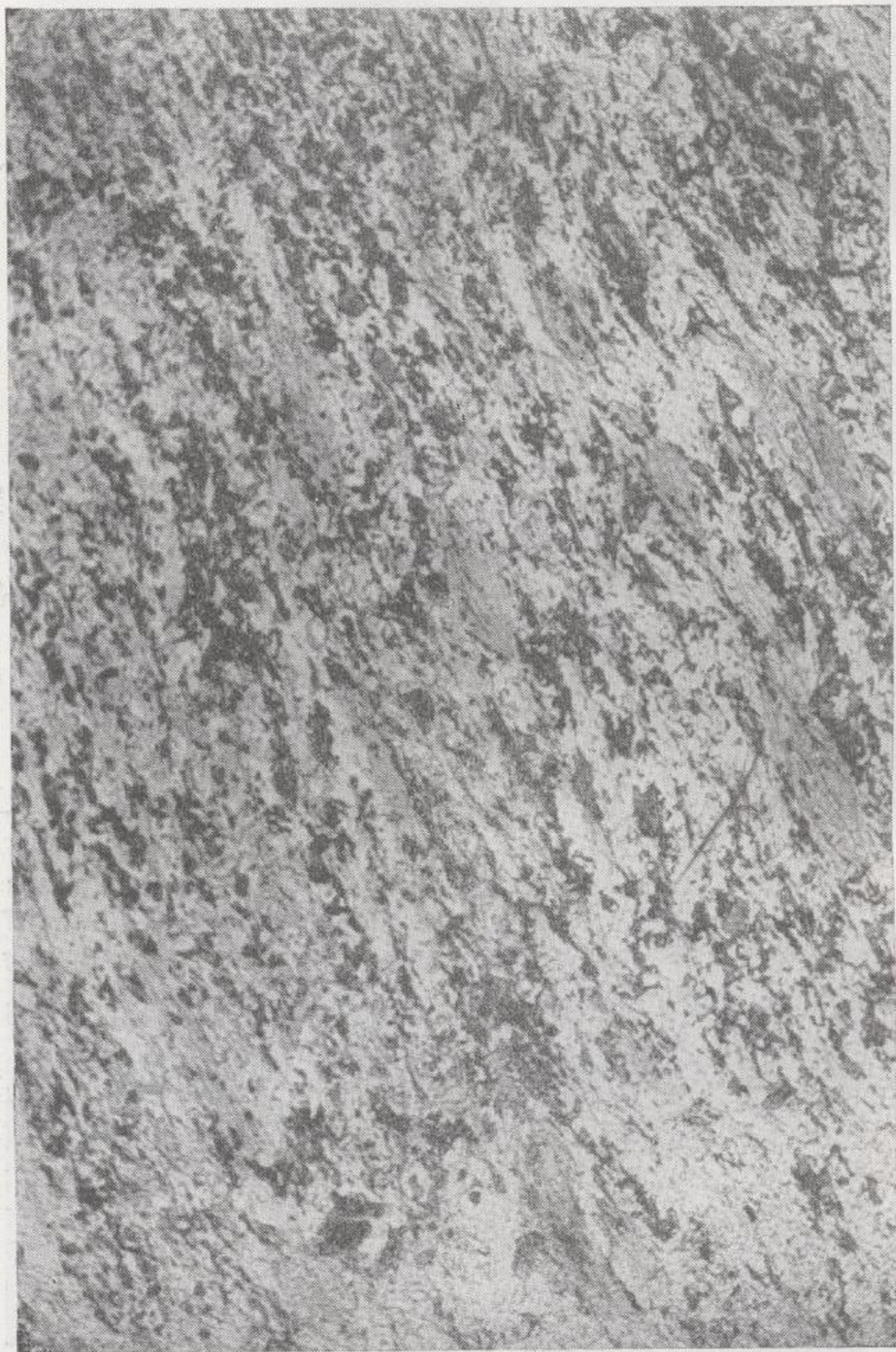
Fig. 6.—Micasquisto anfibólico sin feldespato, tipo a_4 ). Los cristales de anfíbol, xenomorfos, siguen la orientación preferencial de la matriz. Polarizador solo; 10 \times .
