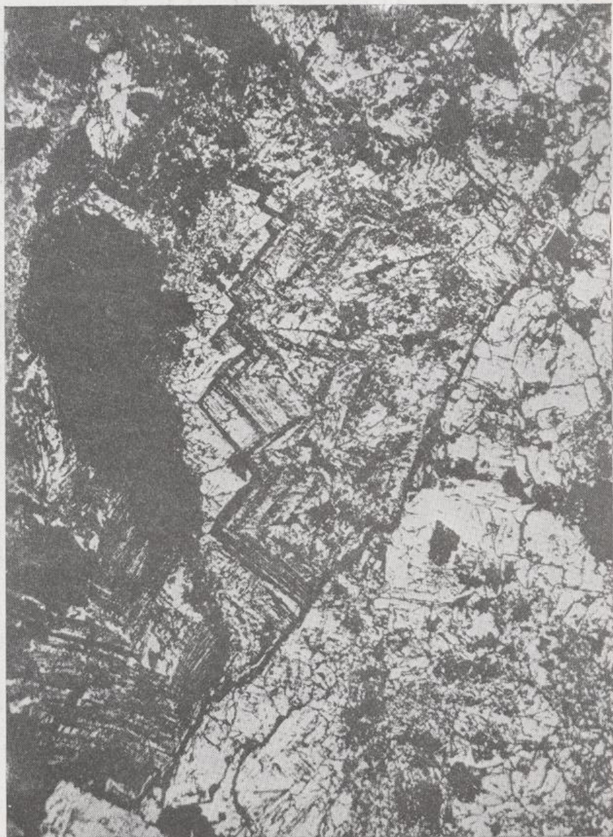
Fig. 4.—Sección pulida \times 25 L. N. Navarredonda, P. P. 760. La única mena asociada que aparece en Navarredonda está representada por pirita (en la foto color blanco). Puede observarse cristales con las caras cúbicas estriadas; formas que van quedando como residuales en el proceso de alteración.
