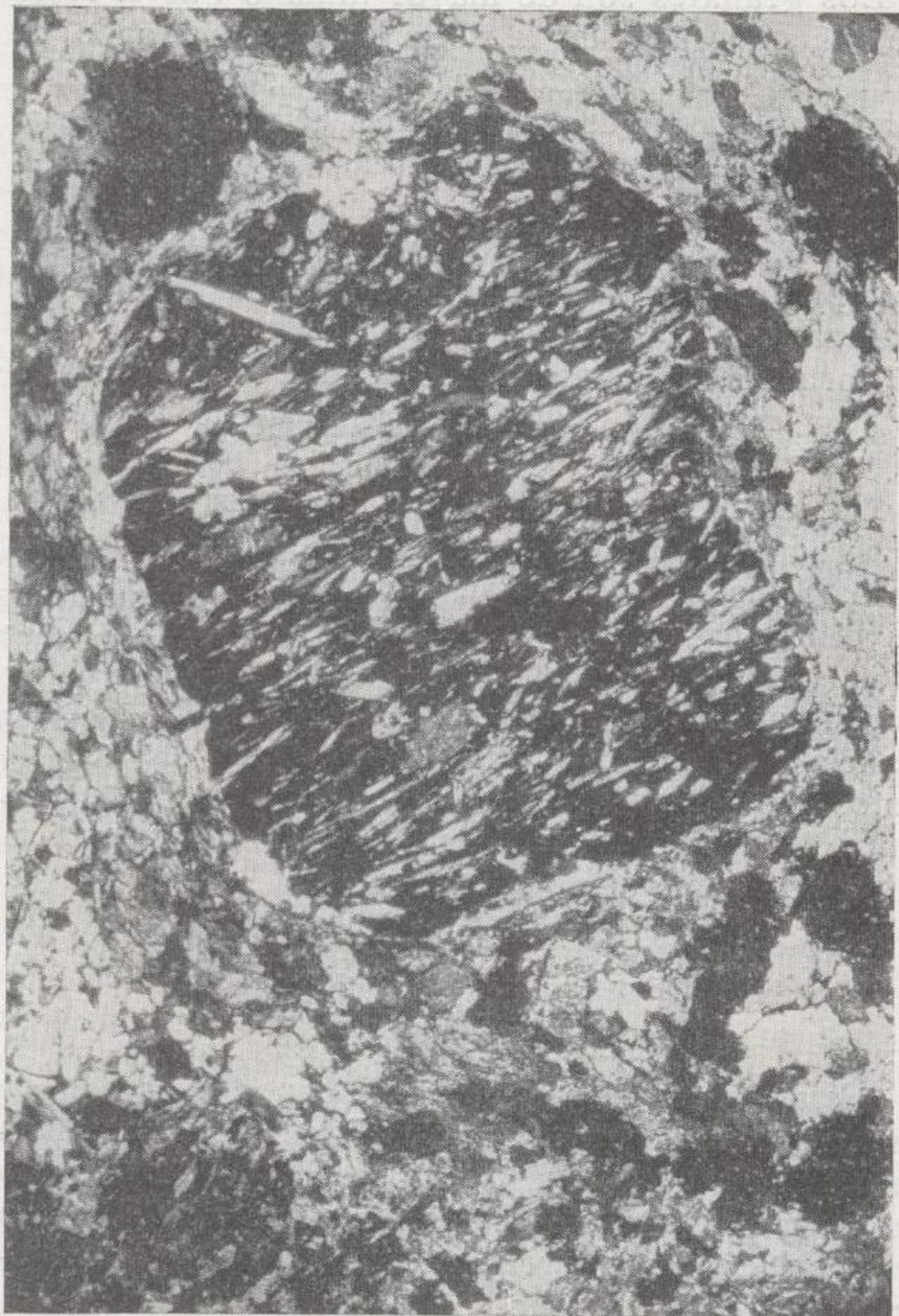
Fig. 15.—Peciloblastos de granate con inclusiones orientadas de anfíbol, rutilo y epidota, en una anfibolita granatífera, tipo c ). Nic. cruzados; 11 \times .
