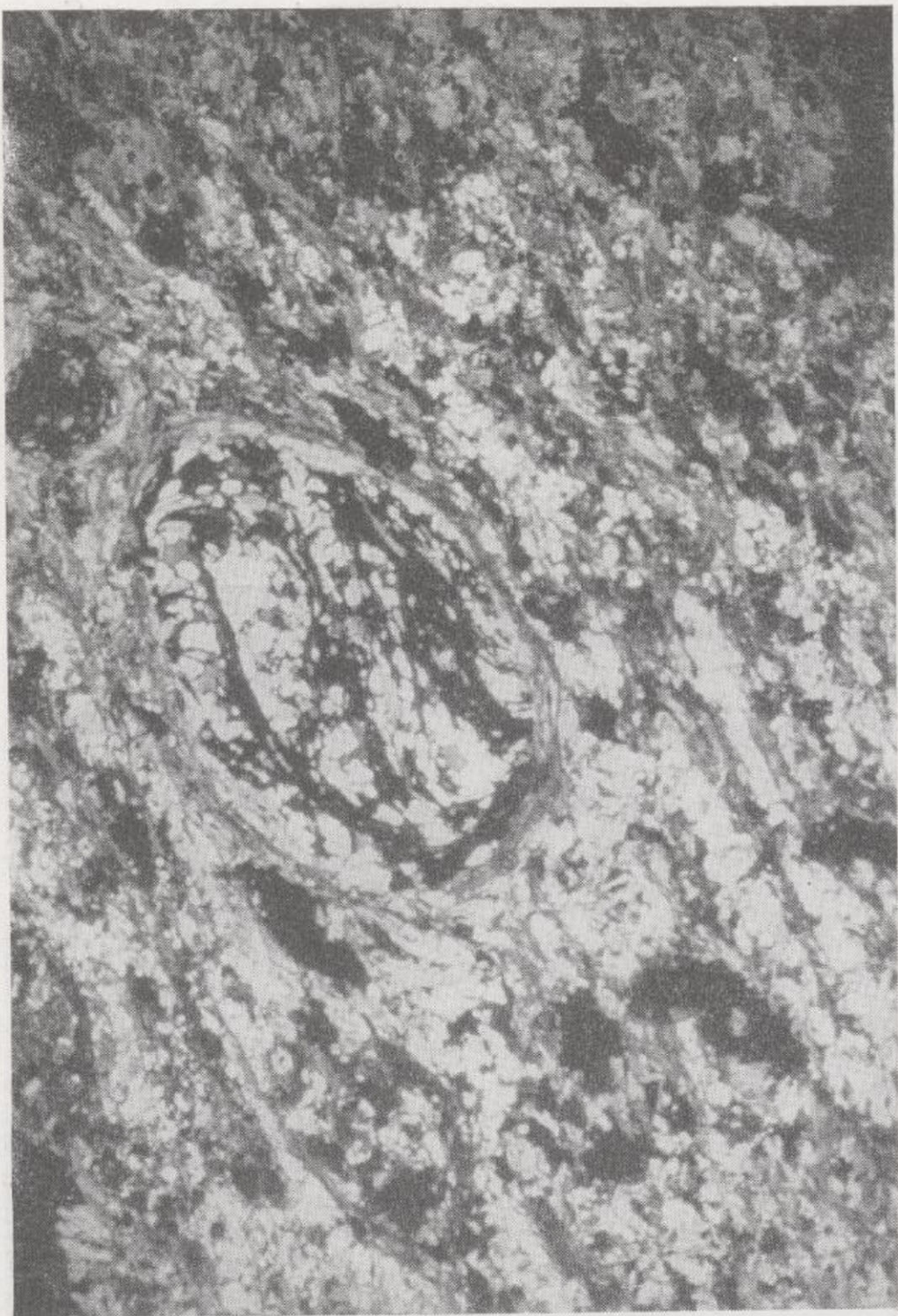
Fig. 11.—Peciloblasto de granate esquelético, en mármol cipolínico con granate y nódulos de siderita, tipo b ). Las inclusiones de cuarzo, muy abundantes, ocupan la mayor parte del peciloblasto. Alrededor del mismo hay una envoltura micácea. Nic. cruzados; 9 ×.
