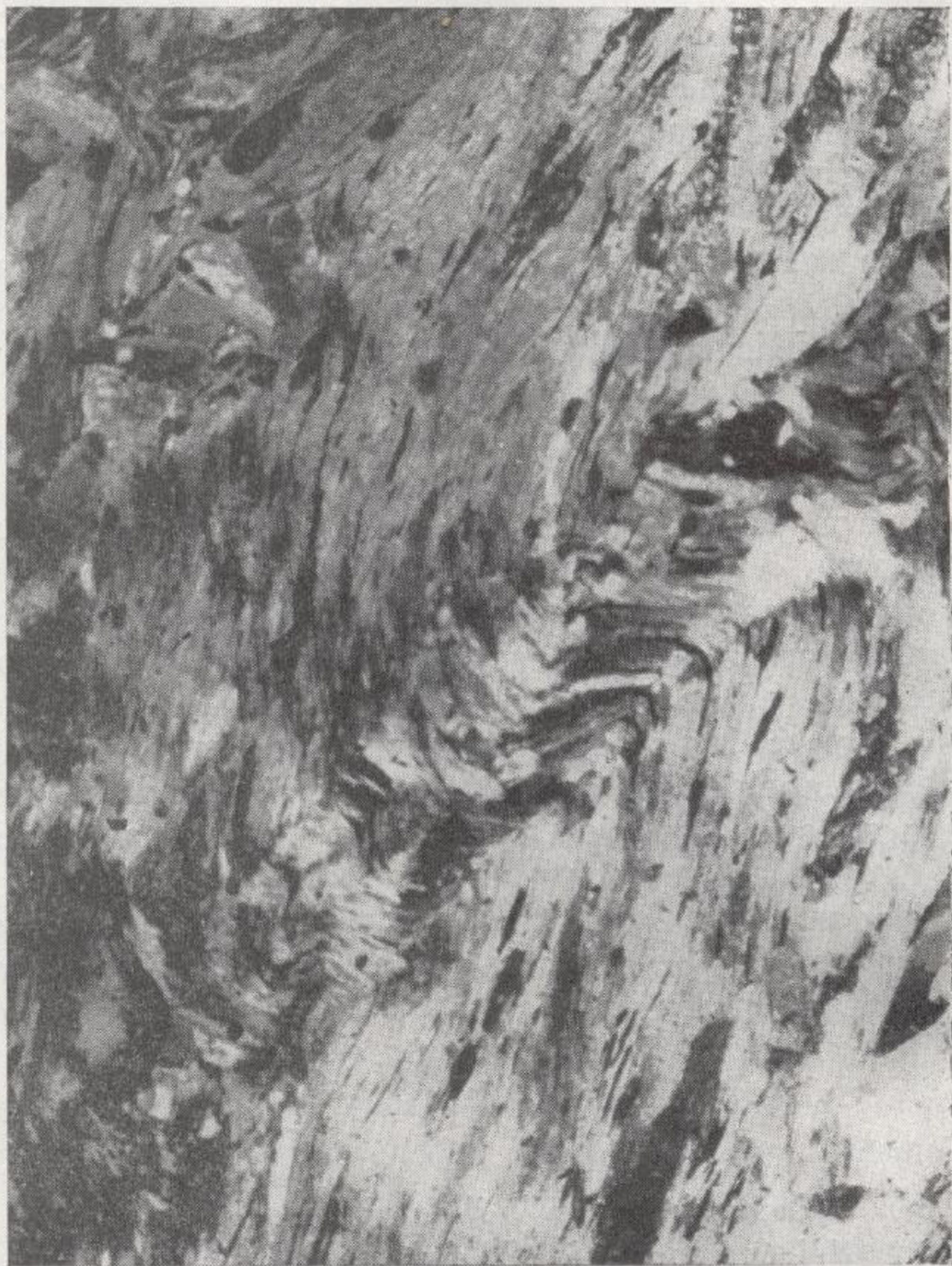
Fig. 3.—Micropliegues en micasquisto granatífero con biotita, tipo a_2 ). Nic. cruzados; 45 \times .
