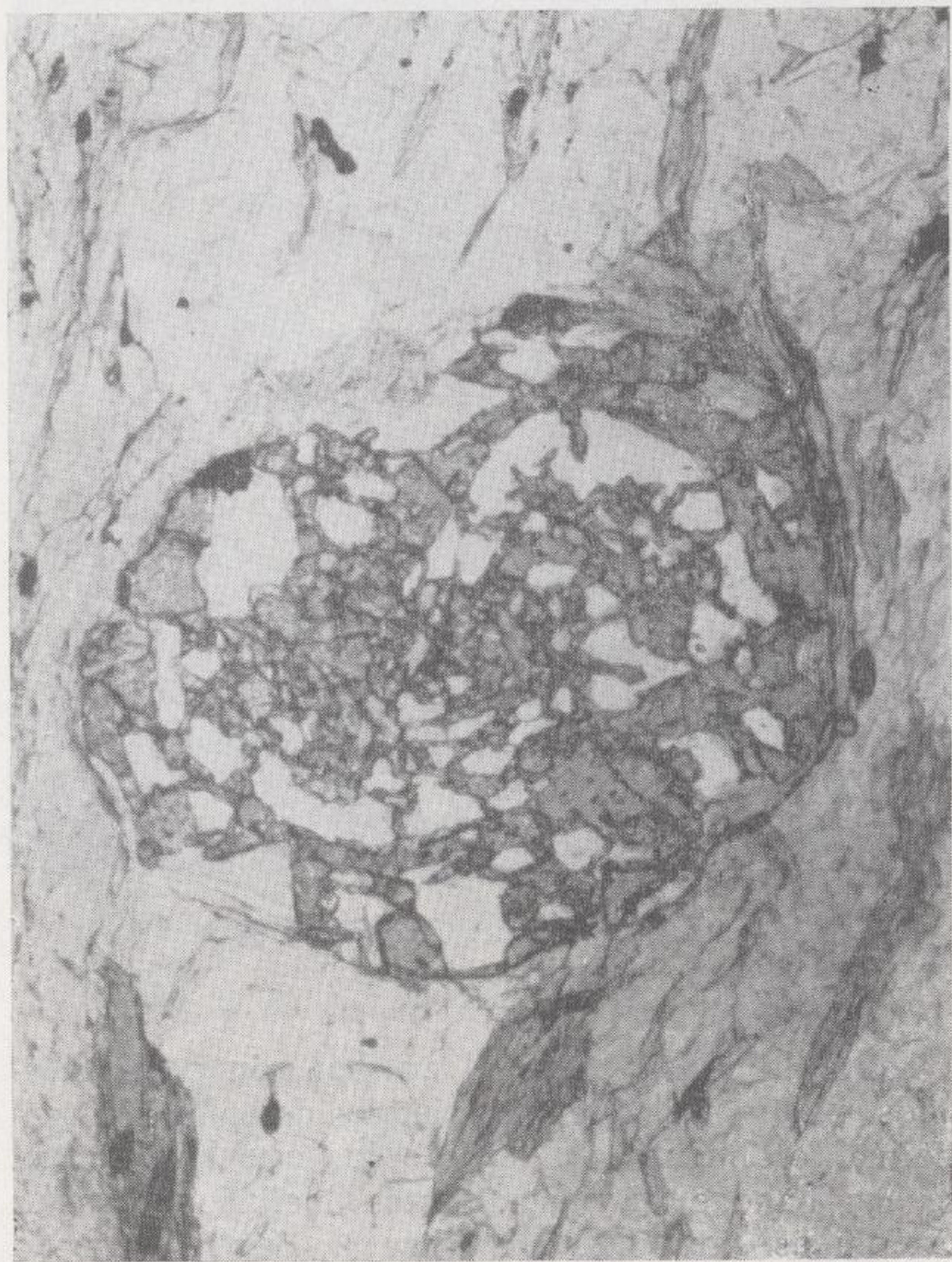
Fig. 1.—Granate peciloblástico con inclusiones de cuarzo, en un micasquisto feldespático anfibólico, tipo a_1 ). Polarizador solo; 34 \times .
