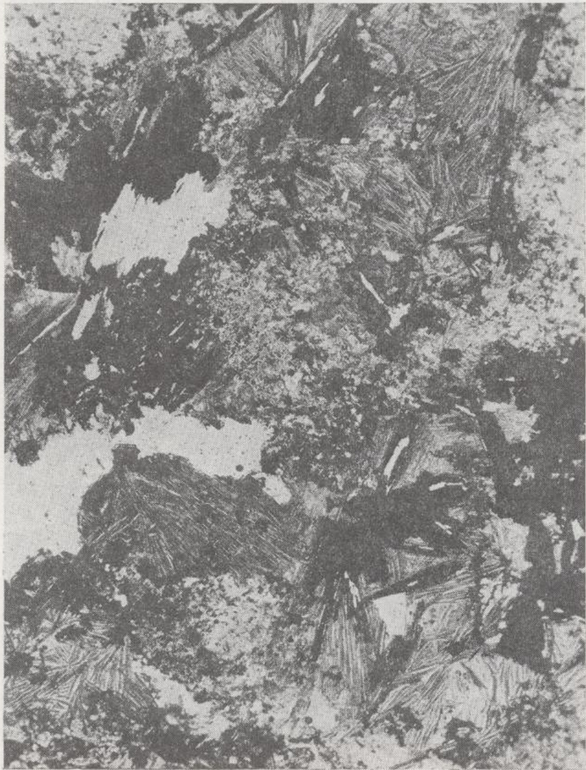
Fig. 2.—Sección transparente \times 25 . L. N. Navarredonda, M. G.513. Trabajos de superficie. Un aspecto de la brecha de cuarzo mineralizada en fosfatos de uranio con cuarzo (color blanco y gris claro), óxidos de hierro (negro) y autunite (agregados escamosos en color gris-negro).
