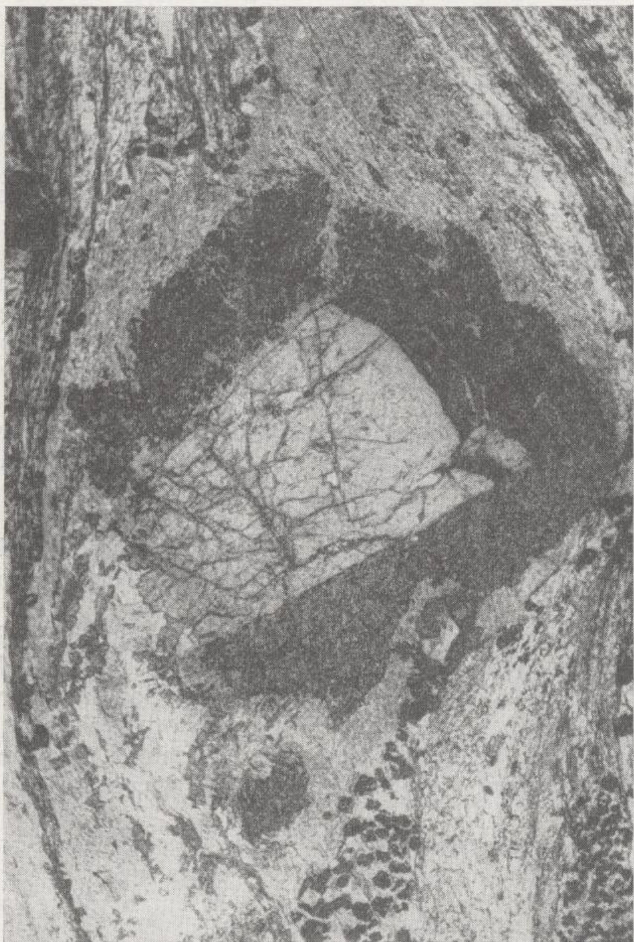
Fig. 8.—Nódulo de estaurolita en un micasquisto del tipo b ). La periferia del cristal, parcialmente alterada, toma un color oscuro debido a la presencia de óxidos de hierro finamente dividido. La forma de nódulo se completa por la envoltura de sericita y cloritoide, productos de alteración final de la estaurolita. Polarizador solo; 11 \times .
