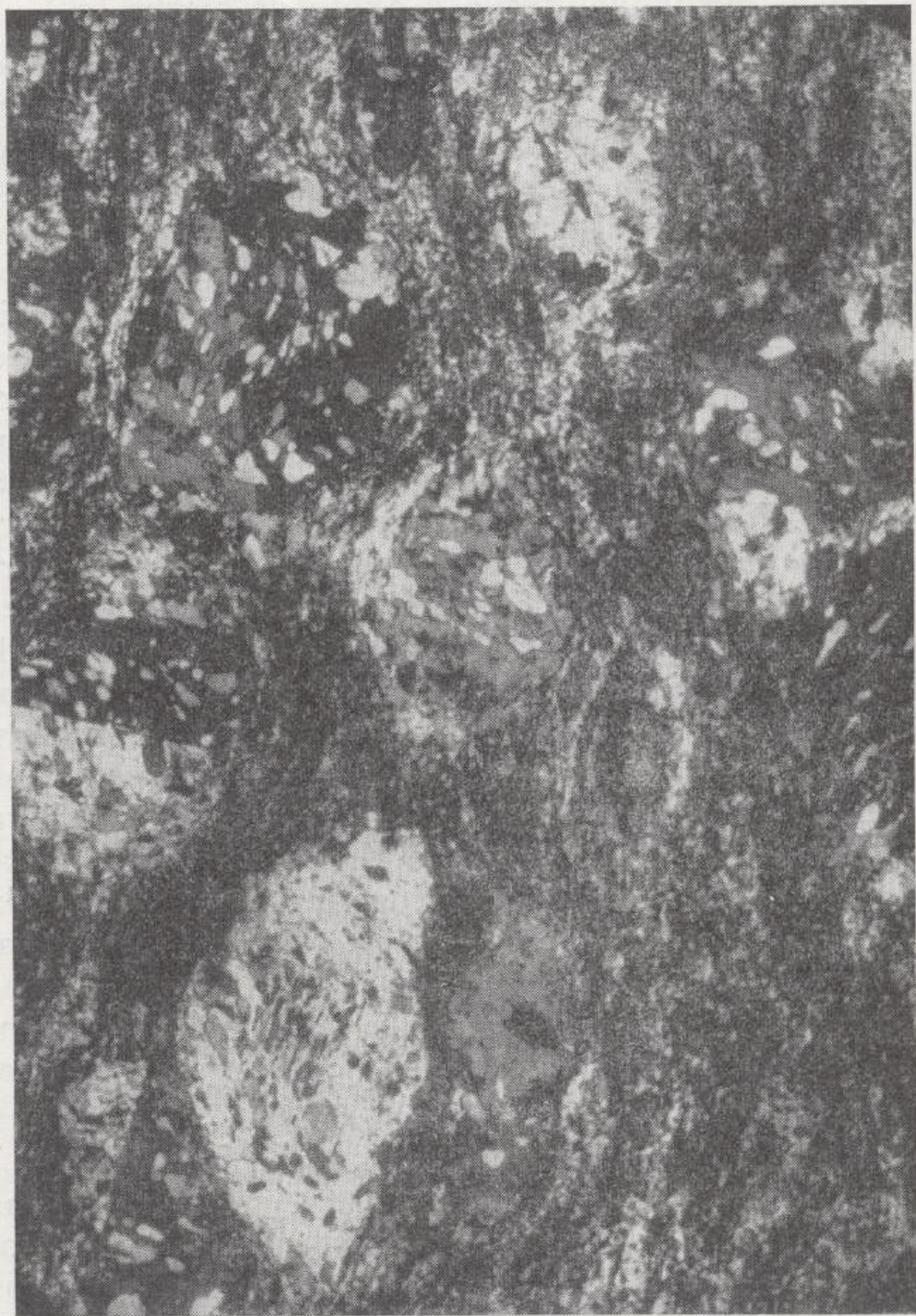
Fig. 5.—Peciloblastos de plagioclasa en micasquisto feldespático del tipo a_3 ). Las inclusiones de cuarzo, epidota, rutilo, y turmalina, tienen una orientación diferente dentro de cada peciloblasto, y están giradas respecto a la orientación preferencial de la mica en la matriz. Nic. cruzados; 15 \times .
