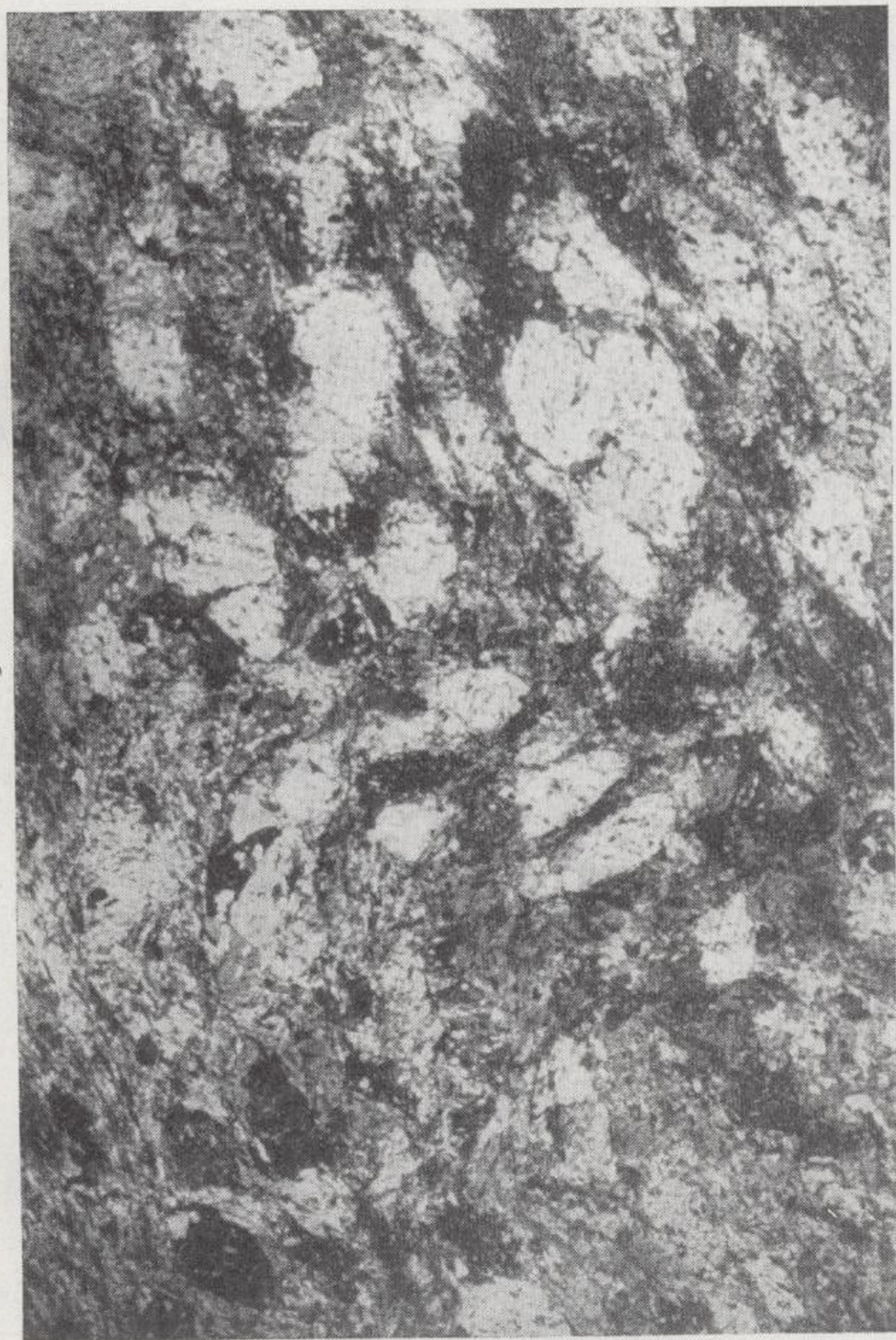
Fig 4.—Micasquisto feldespático, tipo a_3 ). Sustitución de mica blanca por peciloblastos de albita pertenecientes a una paragénesis posterior. Nic. cruzados; 9 \times .
